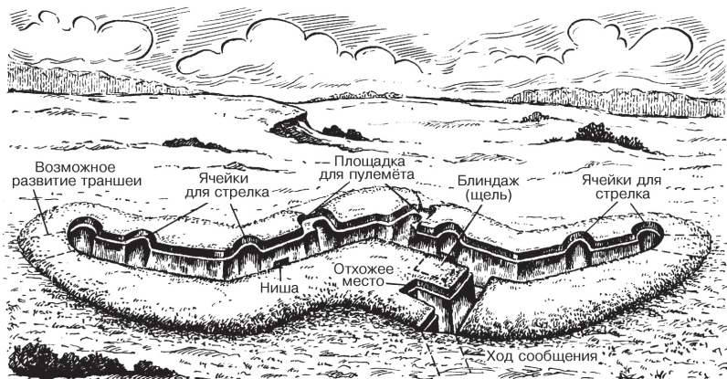
Ячейковый окоп для подразделения с возможностью продолжения траншеи и организации окопов для других подразделений
